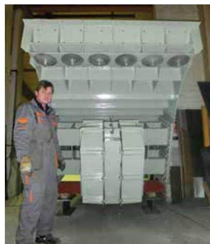
SCHWINGRINNE für Wasserbausteine mit einem Eigengewicht von 13 t.
